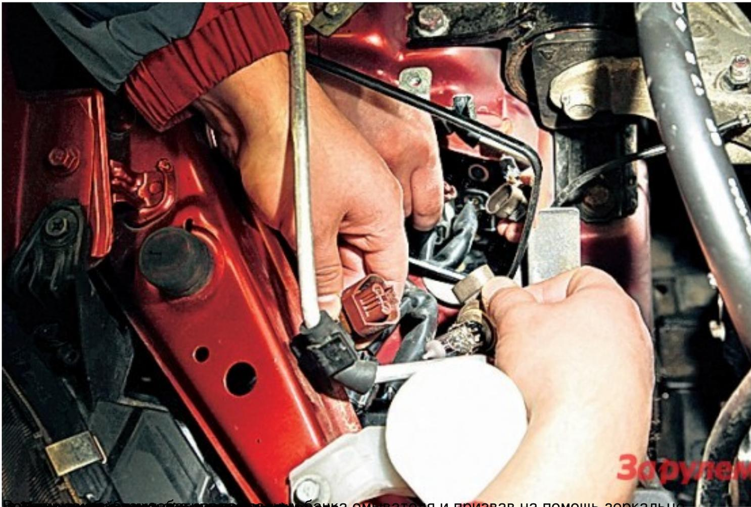
В процессе работы необходимо отсоединить провод от лампы омывателя и призвав на помощь зеркальце,
