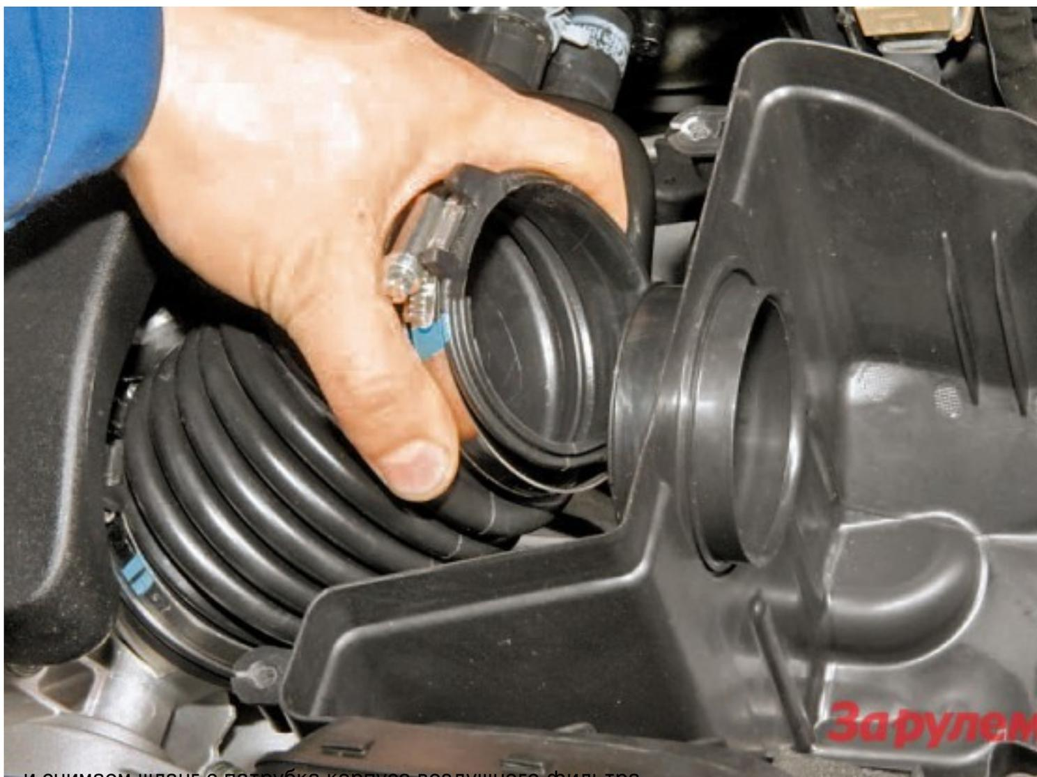
...и снимаем шланг с патрубка корпуса воздушного фильтра.
