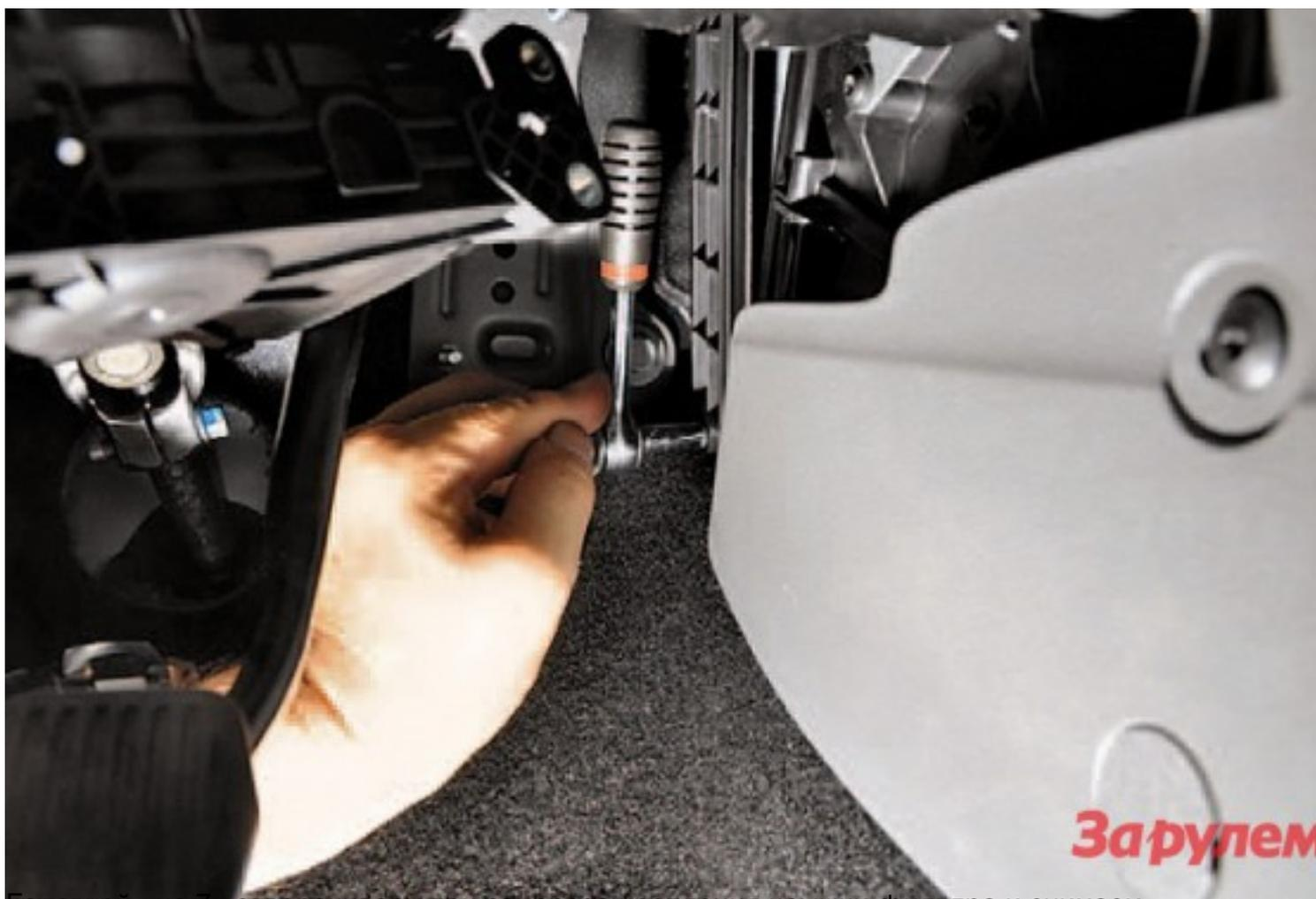
Кривой «на 7» отворачиваем три самореза крепления крышки фильтра и снимаем
