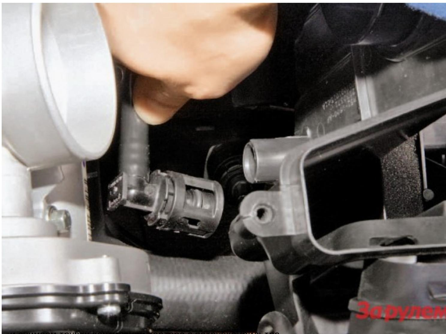
...и снимаем трубку вентиляции картера с патрубка фильтра.
