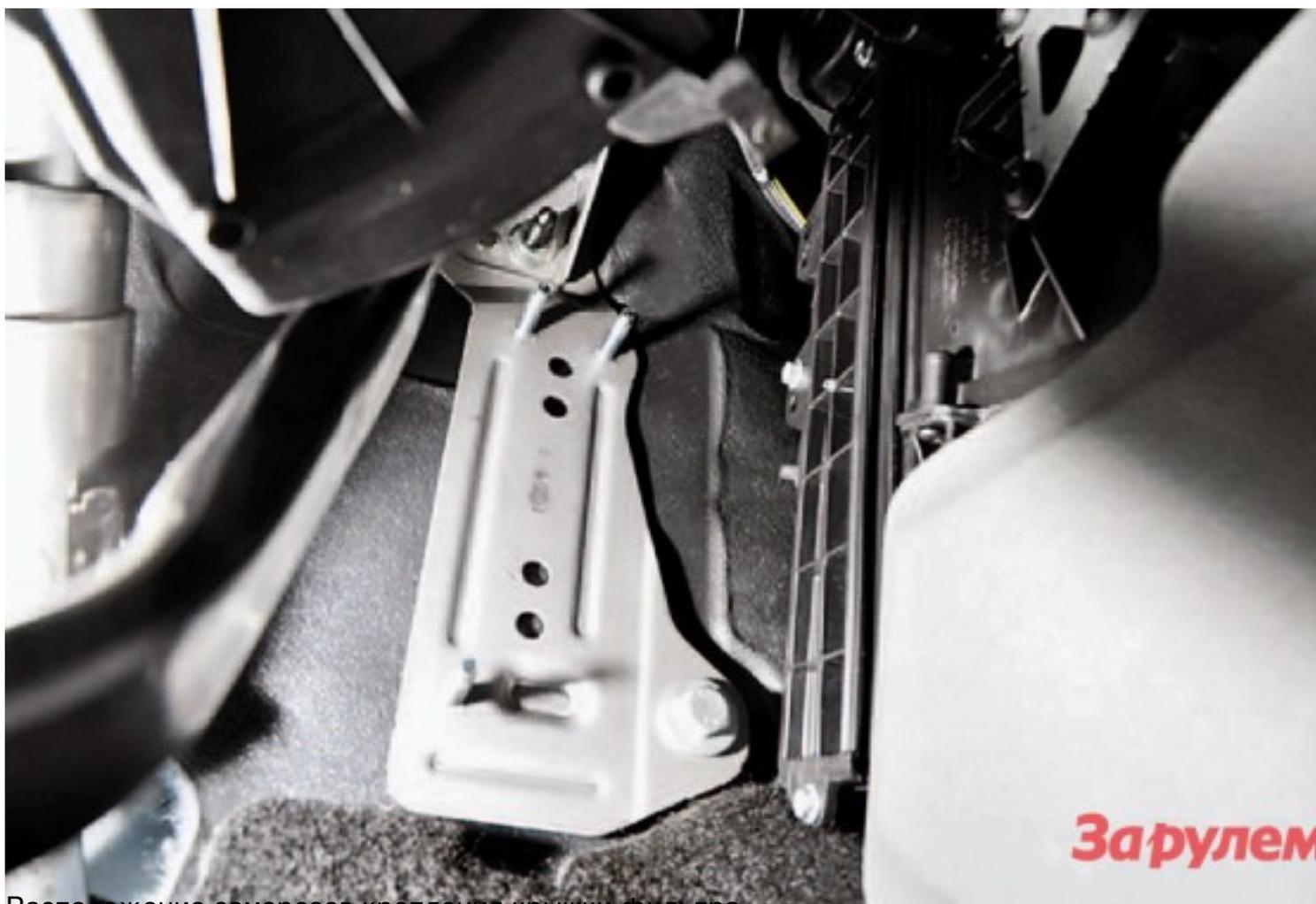
Расположение саморезов крепления крышки бампера
