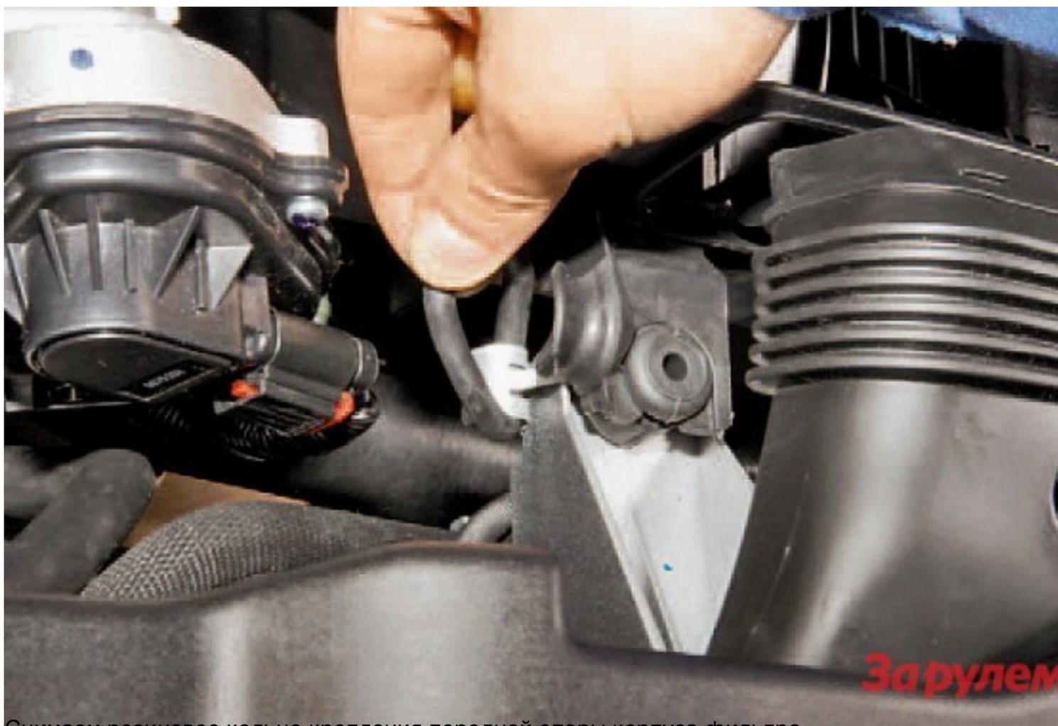
Снимаем резиновое кольцо крепления передней опоры корпуса фильтра.
