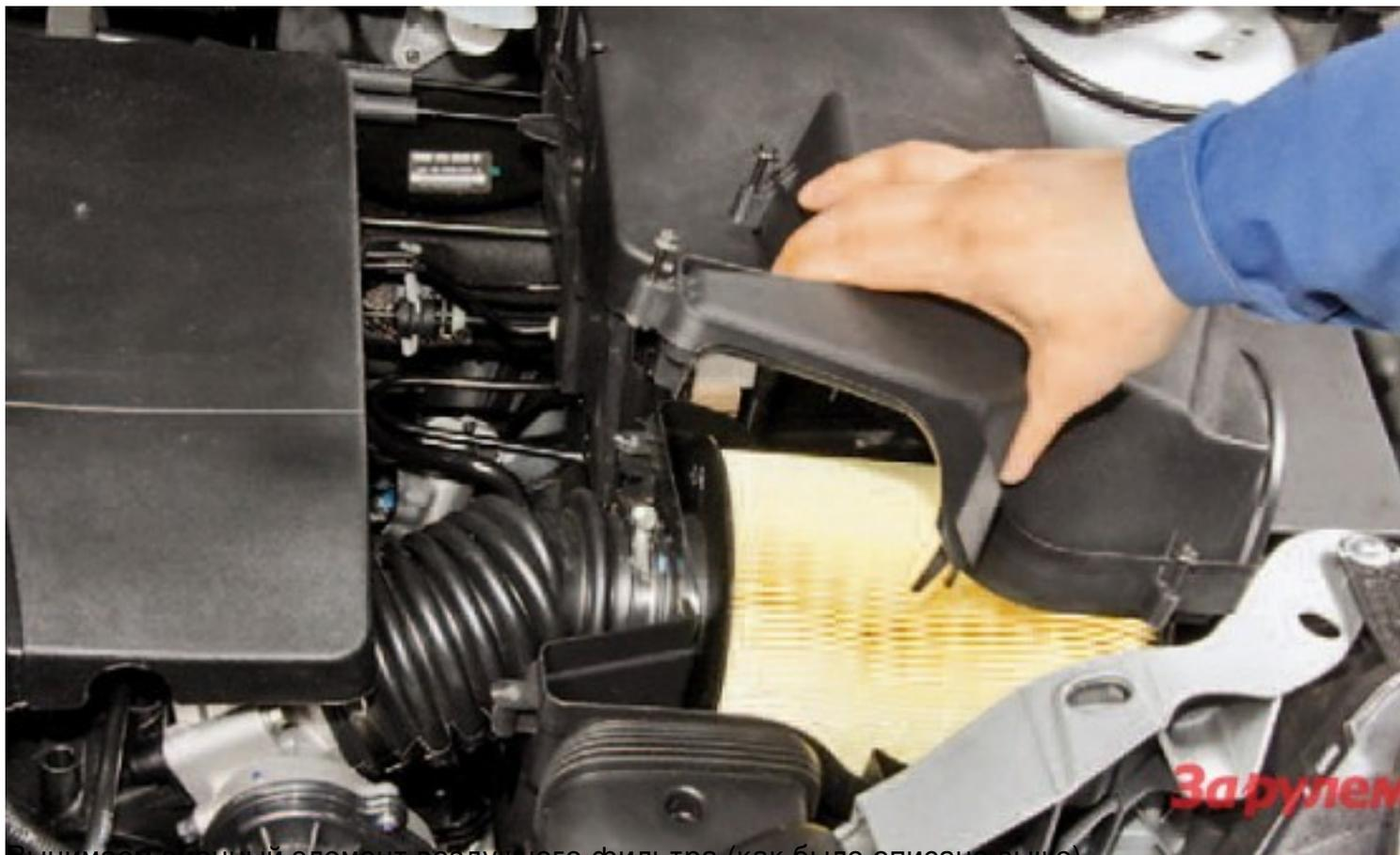
Вынимаем сменный элемент воздушного фильтра (как было описано выше).
