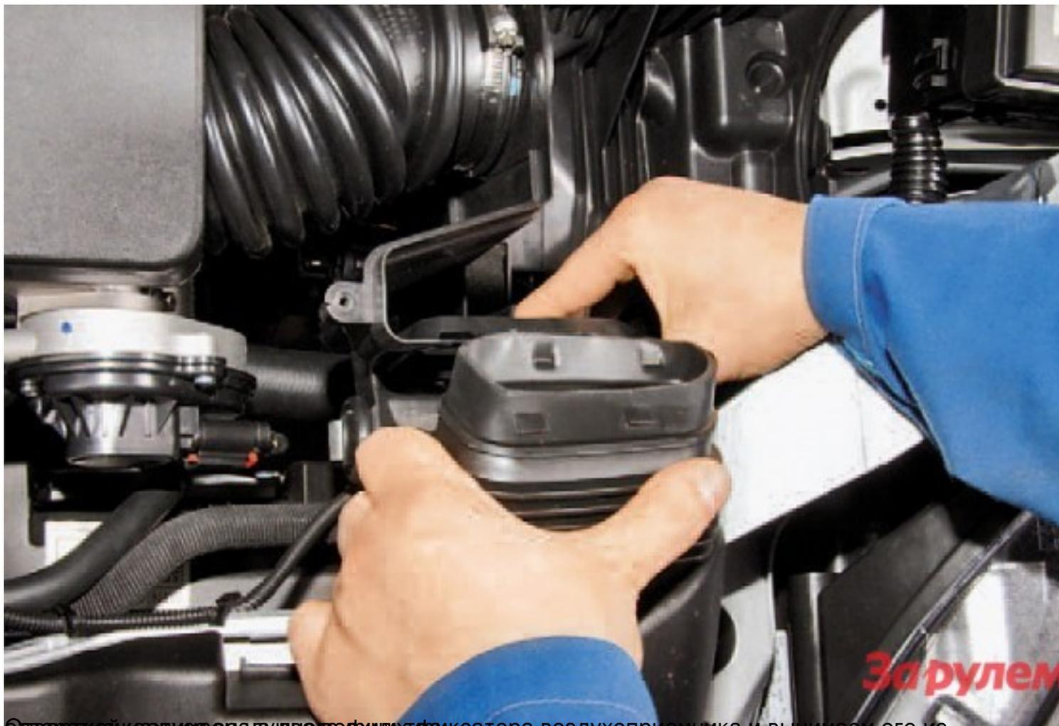
Оплеткой картера воздушного фильтра фиксируем воздухоприемник и вынимаем его из
