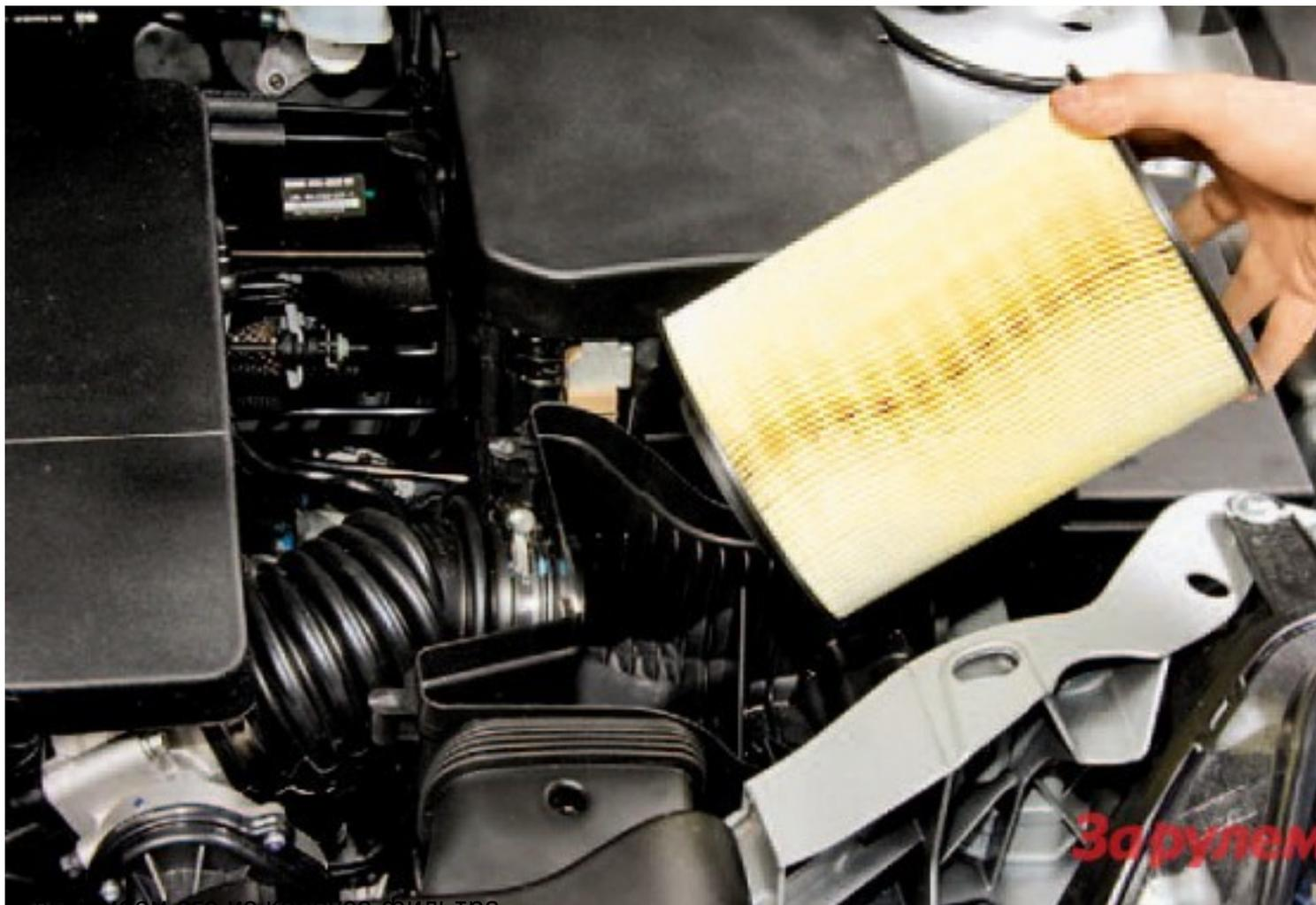
...вынимаем его из корпуса фильтра.
