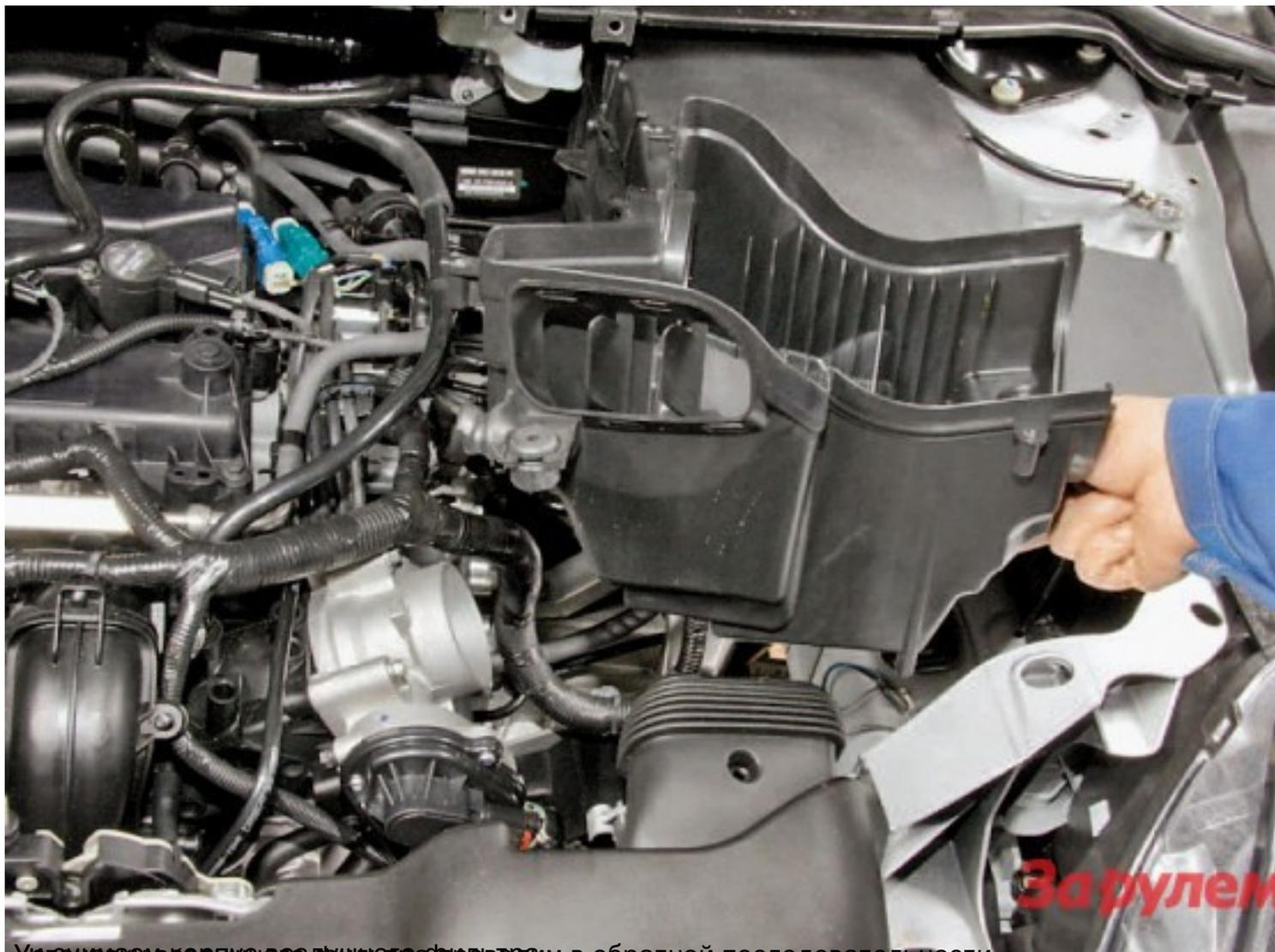
.Устанавливаем воздушный фильтр в обратную последовательность.
